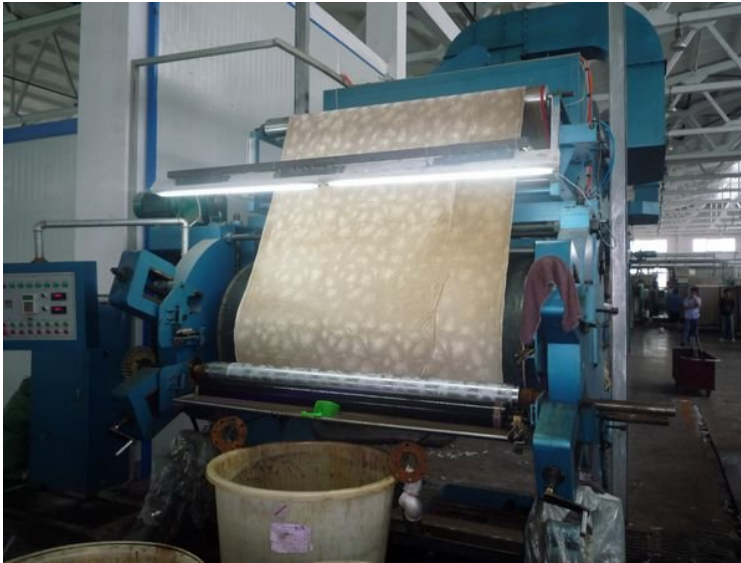
Typický 8-válcový tiskací stroj s centrálním válcem
