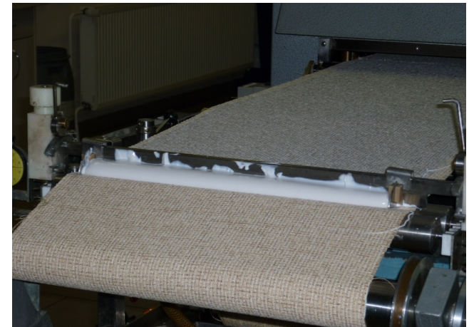
1 - tkanina před úpravou, 2 - tkanina s apretem, 3 - vodící válce, 4 - pryžový pás, 5 - kruhová rotační šablona, 6 - stěrka,
