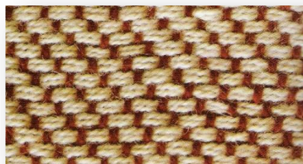
Útkový efekt třívazného kepru
