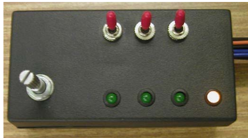
Obrázek č. 2. Malý ovládací panel pro digitální vstupy a žádanou hodnotu otáček.
