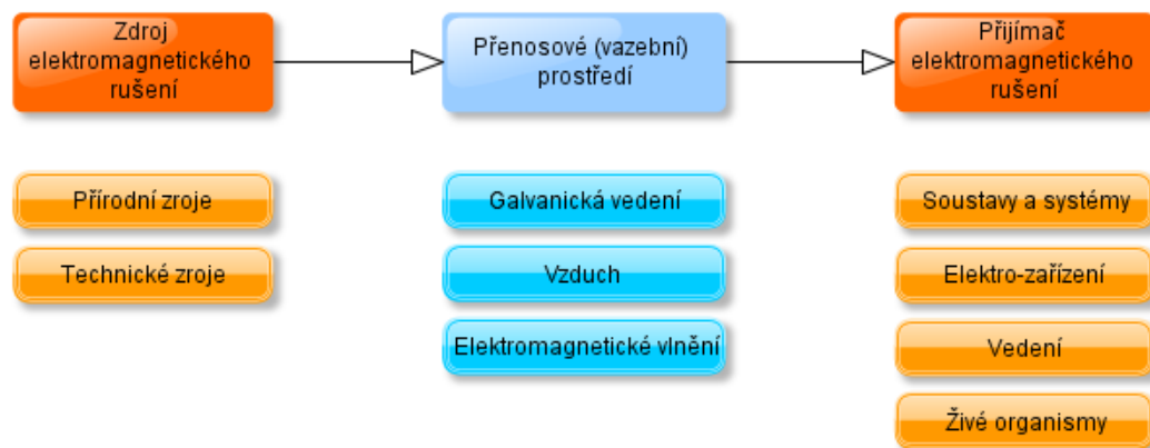
Obr. 10-12 Signálový řetězec EMC
