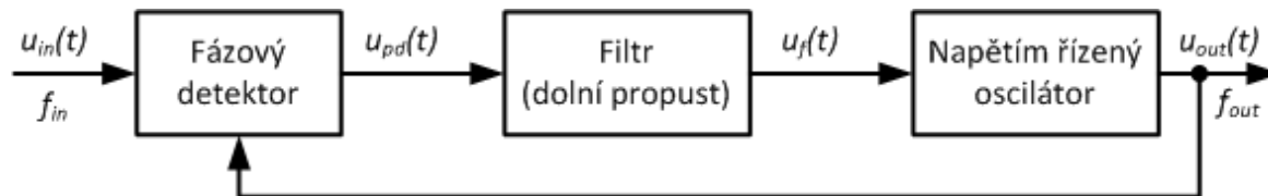
Obr. 9-9 Blokové schéma fázového záměru
