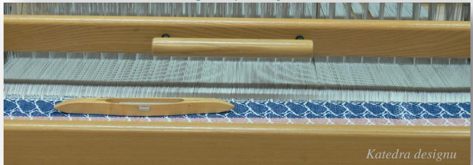
Na horním obrázku tkací jehla, na spodním obrázku člunek
