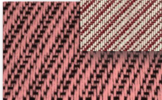
10vazný třířádkový kepr pravého směru utkaný na vzorovacím stávků Megado pomocí 16 listů, D_o je větší než D_u
