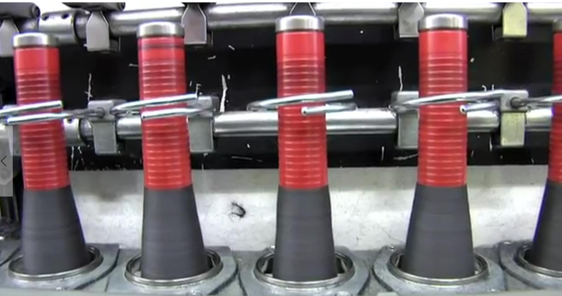
příze na potáčích – prstencový dopřádací stroj
