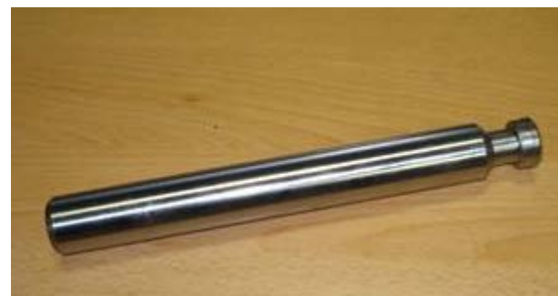
Píst (plunžr) paletového vozíku
