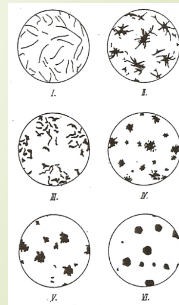
Etalony tvarů grafitů dle ČSN EN 1560
