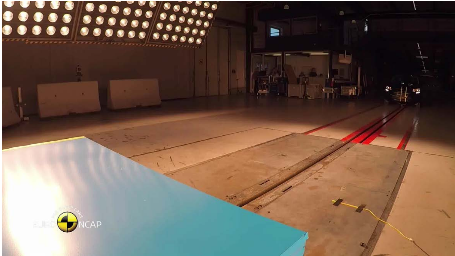
Čelní náraz do deformovatelné překážky (přesazení 40%)
