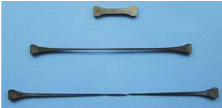
Využití TWIP efektu u hlubokotažných materiálů (deformace > 1000 %)
