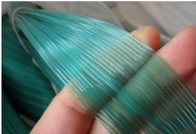
Monofil = DT tvořená jedním nekonečným vláknem
