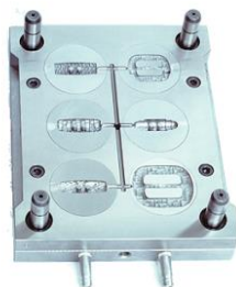
Vstřikovací forma (tvárník, tvárnice s vtokovou soustavou)
