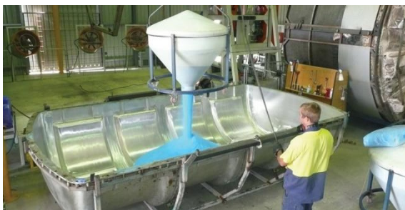
Dávkování práškového plastu do formy
