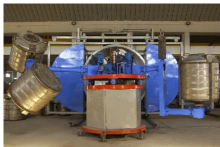
Pracoviště: formy, rotační zařízení, pec
