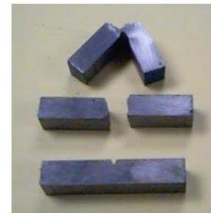
Obr. 2 Zlomený vzorek po rázové zkoušce
