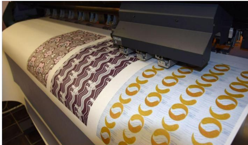
Záběr na přejezd tiskové hlavy při tisku na přenosové médium
