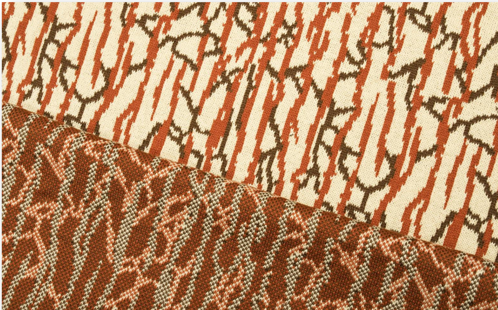
Žakárská zátažná oboulicí pletenina, podkládaná vazba s keprovým rubem
