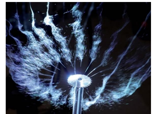
➤ Záznam procesu výroby nanovláken
