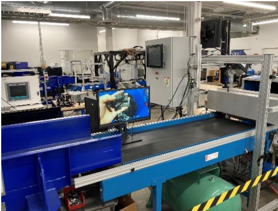
Automatizovaná recyklační linka pro plazmové televize
