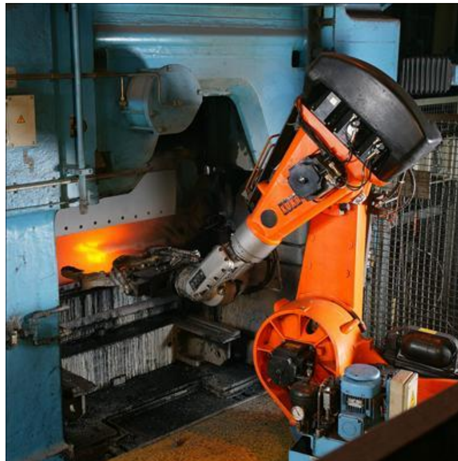
Zakládání výrobků do pecí, teplotně odolné roboty
