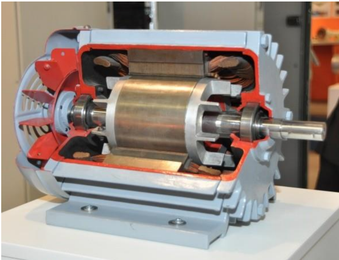
Řez třífázovým asynchronním motorem s kotvou nakrátko
