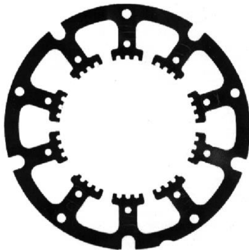
a) Příčný řez státorem (bez vinutí)
