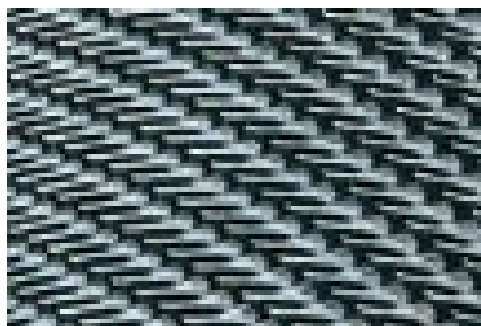
Jemný pilkový povlak čechracího válce hmotnost chomáčků cca 0,5mg [1]
