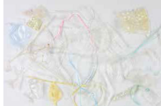
Lesklé příměsi detekované G-modulem [1]
