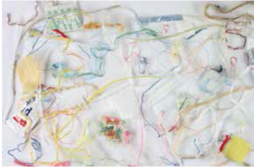
Příměsi detekované barevným modulem [1]
