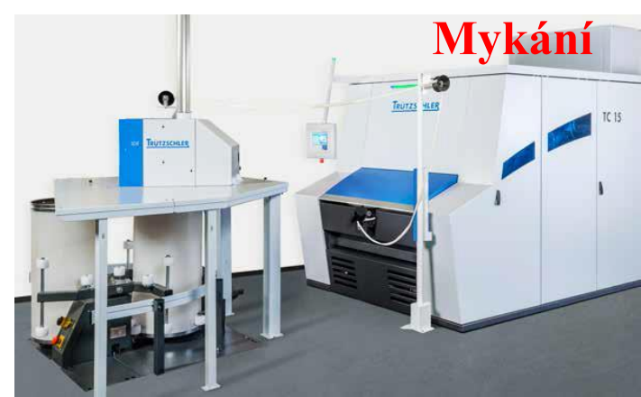
Mykací stroj s integrovanou průtahovou hlavou [1]
