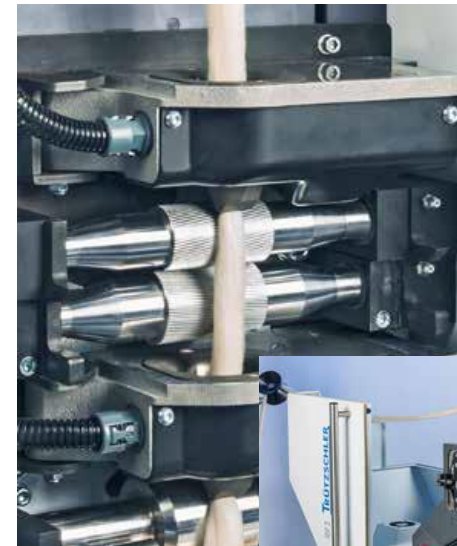
Mykací stroj s integrovanou průtahovou hlavou [1]
