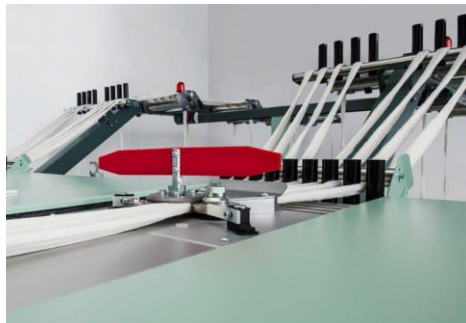
Družení pramenů na vstupu do stroje [1]
