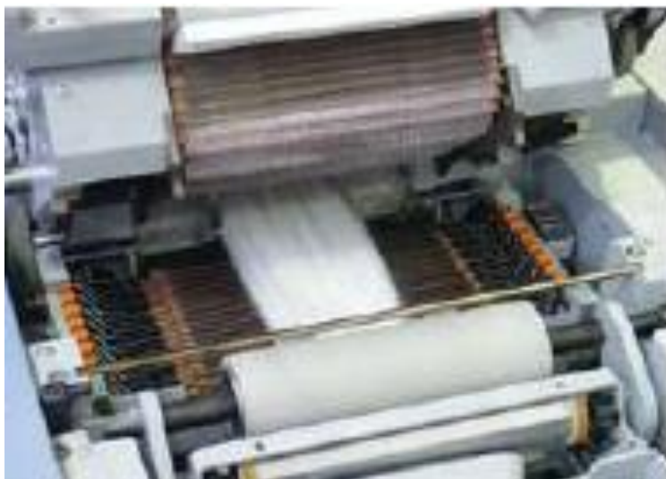
Průtahové ústrojí - hřebeny unášené řetězem (horní část) + vodícími lištami (spodní část) [3]
