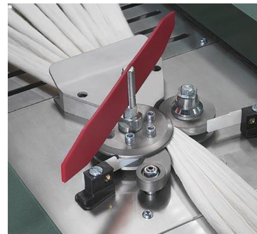
Regulace HN na PS – snímání tloušťky pramene [1]
