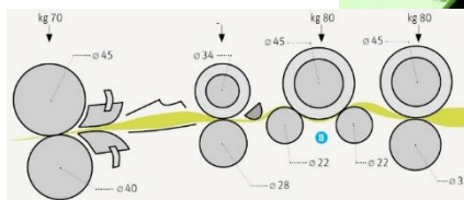
Průtahové ústrojí 3/4 s přítlačnou tyčí – posukovací stroj UM -TRN - Marzoli [4]
