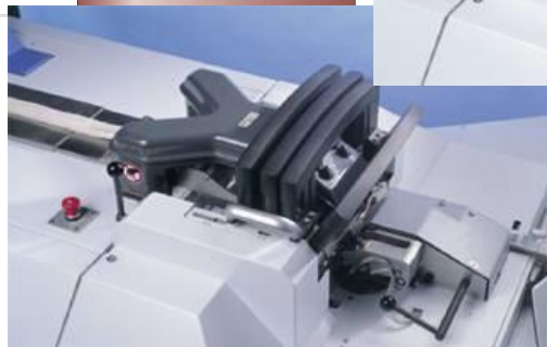
Průtahové ústrojí 4/3 s přítlačnou tyčí + svinovací hlava – posukovací stroj TD 03 – schéma [2]
