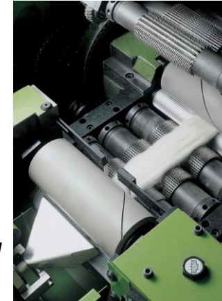
Průtahové ústrojí s ozubenými válečky – posukovací stroj – fa Sant Andrea Novara [1]
