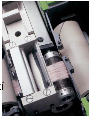
Průtahové ústrojí s vodícími válečky a ojhleným válcem – posukovací stroj - vlnařská čes. techn. - fa Sant Adrea Novara [1]
