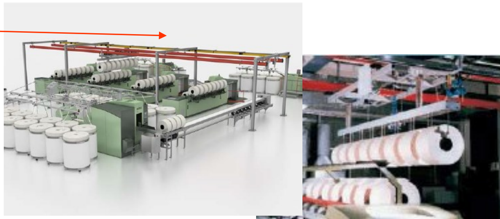
Automatický transportní systém (Servolap - Rieter) [2],[3]
