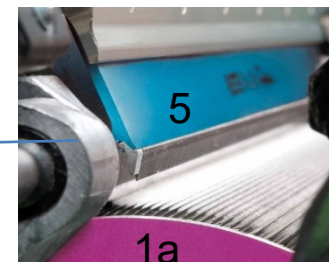
Detail pročesávání třísně česacím bubnem [4]
