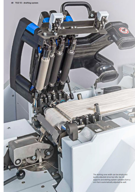
Průtahové ústrojí na výstupu z česacího stroje [1]
