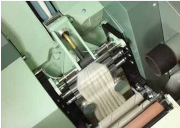
Průtahové ústrojí na výstupu z česacího stroje [2]
