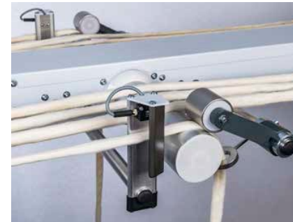
Senzor pro přítomnosti a pohybu kontrolu pramene [1]
