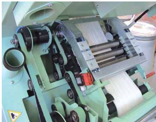
UNilap E32 – 2 zónové průtahového ústrojí a jeho schéma [4]
