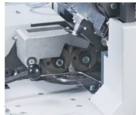
Měření tloušťky pramene na česacím stroji [1]
