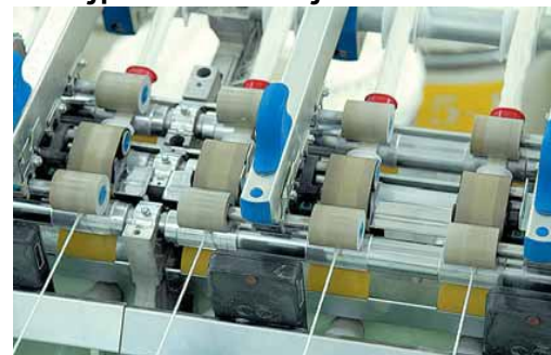
3 válečkové dvouřemínkové průtahové ústrojí křídlového předpřádacího stroje F15 – Rieter [3]
