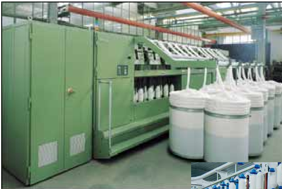
Křídlový předpřádací stroj BF20 – fa Finlane group [2] vlnářská česaná technologie
