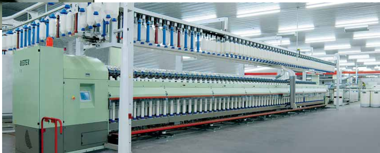
Křídlový předpřádací stroj F15 s automatickým smekacím zařízením – fa Rieter [1] - ba technologie
