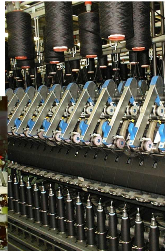
Prstencový dopřádací stroj FP – Gaudino – vlnářská česaná technologie [1]
