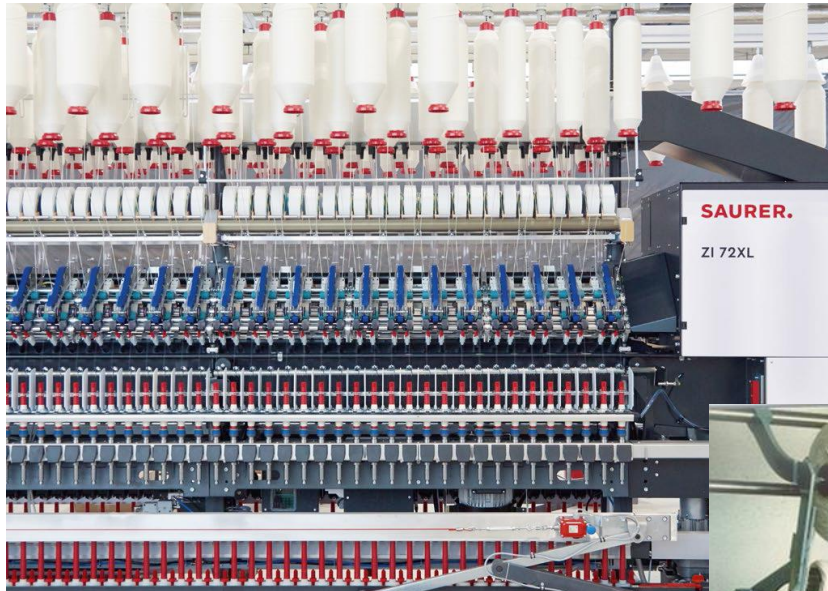
Prstencový dopřádací stroj – bavlnářská technologie – fa Saurer [2]
