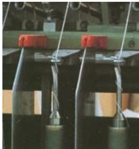
Vřeteno s palcem– detail (mykaná vlna) - fa HDB [1]
