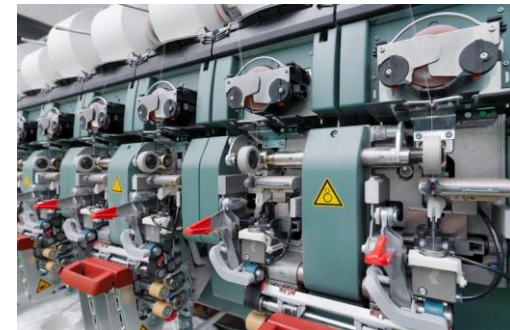
Detail tryskového dopřádacího stroje Rieter J26 [1]
