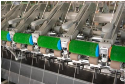
Detail prstencového dopřádacího stroje G32 Rieter [1]
