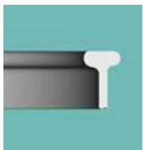
Průřez přírubového prstence - profil T pro „C“ běžce [3]
