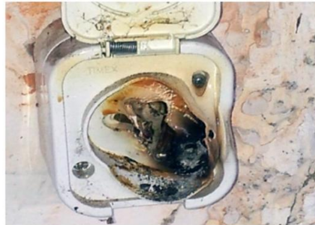
Obr. 3 Spálená zásuvka vlivem sériové poruchy
