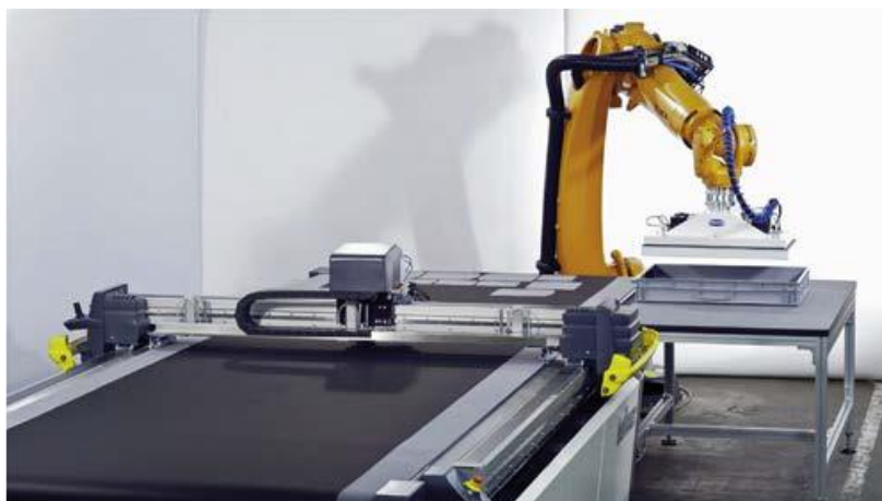
Obrázek 2.2 Roboty Bullmer a KUKA s vakuovým chapačem manipulují se vzorovými kusy [4]
