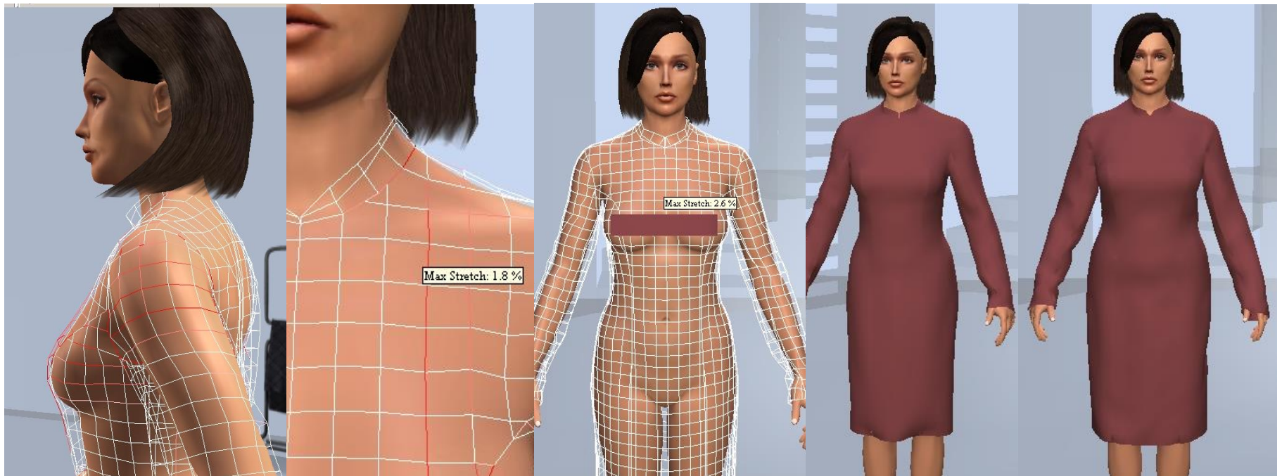
Simulace padnutí oděvu, zobrazení příliš napnutého materiálu, neomezené množství typů těla a velikostí.
