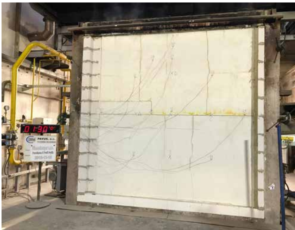
Zkouška oboustranně omítnuté příčky z cihel Porotherm 8 Profi vyzděných na zdicí pěnu Porotherm Dryfix
