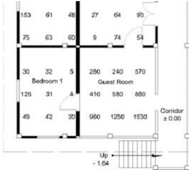
Příklad sítě kontrolních bodů pro posouzení příspěvku denního světla v místnostech s trvalým pobytem osob
