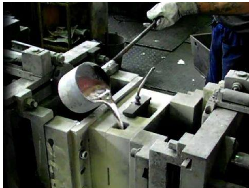
Jednoduchá dělená forma umístěná na licím stroji s ruční obsluhou
