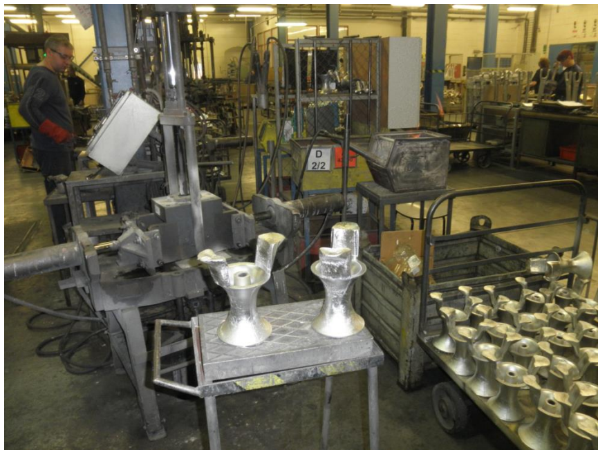
Jednoduchá dělená forma umístěná na licím stroji s ruční obsluhou
