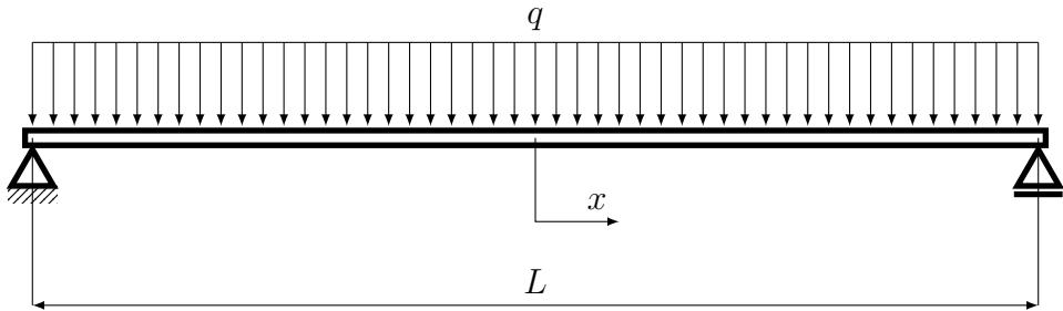
Ohybový moment  $M_o(x)$  stanovíme metodou řezu nebo pomocí Schwedlerovy věty:
