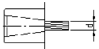
válcová koncovka zalitá kovem nebo epoxidem (může mít vnější/vnitřní závit, nebo oka pro přípoj)
