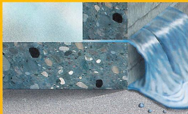
Netěsná pracovní spára
