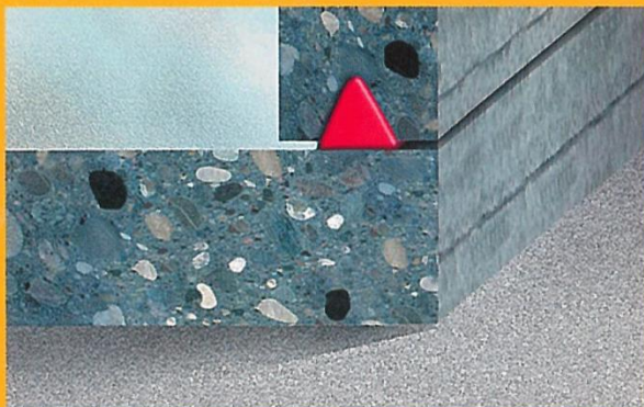
Spára utěsněná tmelem SikaSwell® S-2
