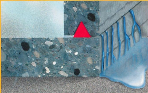
Částečné utěsnění po aplikaci tmele SikaSwell® S-2
