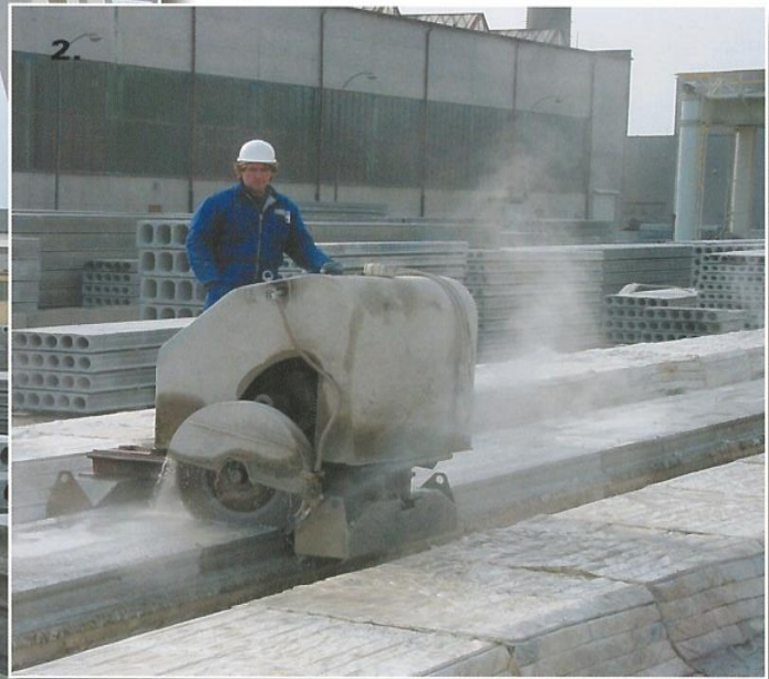
2. Dělení pásu na jednotlivé dílce
