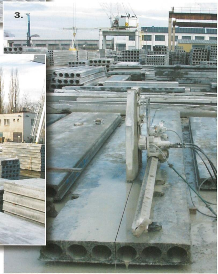
2. Dělení pásu na jednotlivé dílce
