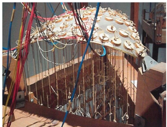
Experimentální ověření chování skořepiny zvoleného tvaru
