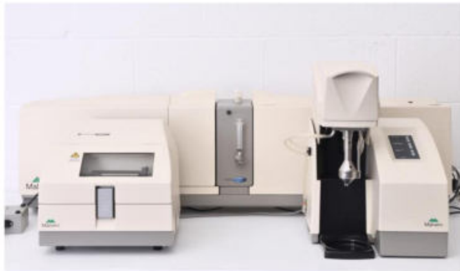
Mastersizer 2000 od firmy MALVERN, umožňujícím měřit distribuci velikosti částic v rozmezí 0,01 – 2000 \mu\text{m} . (ORLEN UniCRE)
