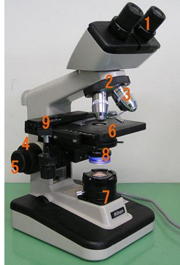
1) eyepieces, 2) revolver, 3) lenses, 4) macro screw, 5) microscrew, 6) table, 7) light source, 8) condenser and aperture, 9) cross shift
