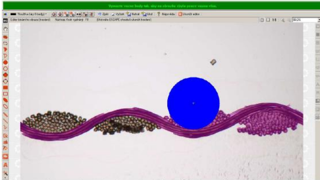
Obr. 8: Překryvnový (binární) obraz vazné vlny s barevným obrazem celého řezu tkaniny, modrým kruhem uživatel odstraňuje binární obraz řezů příže ve tkanině
