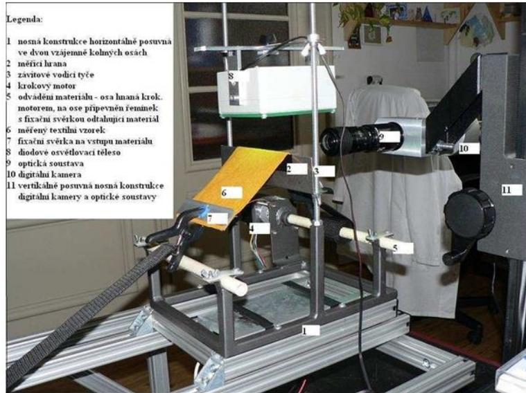
Obr. 3: Detail RCM systému s popisky jednotlivých funkčných častí
