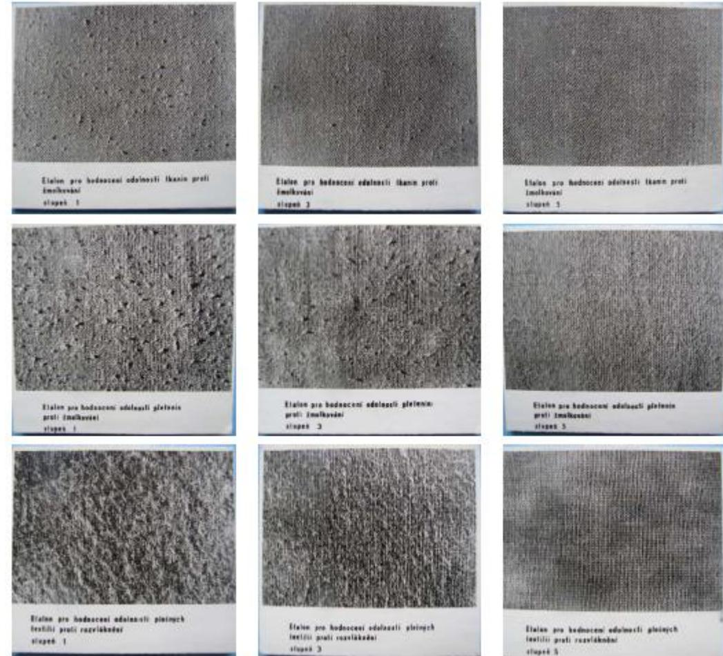
Obr. 7 Tři sady fotografických etalonů pro stanovení stupně žmolkovitosti vzorků různých typů textilií testovaných na Komorového žmolkovacího přístroje.
