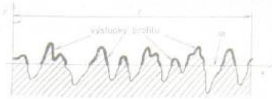
Obr. 15: Výstupky profilu
