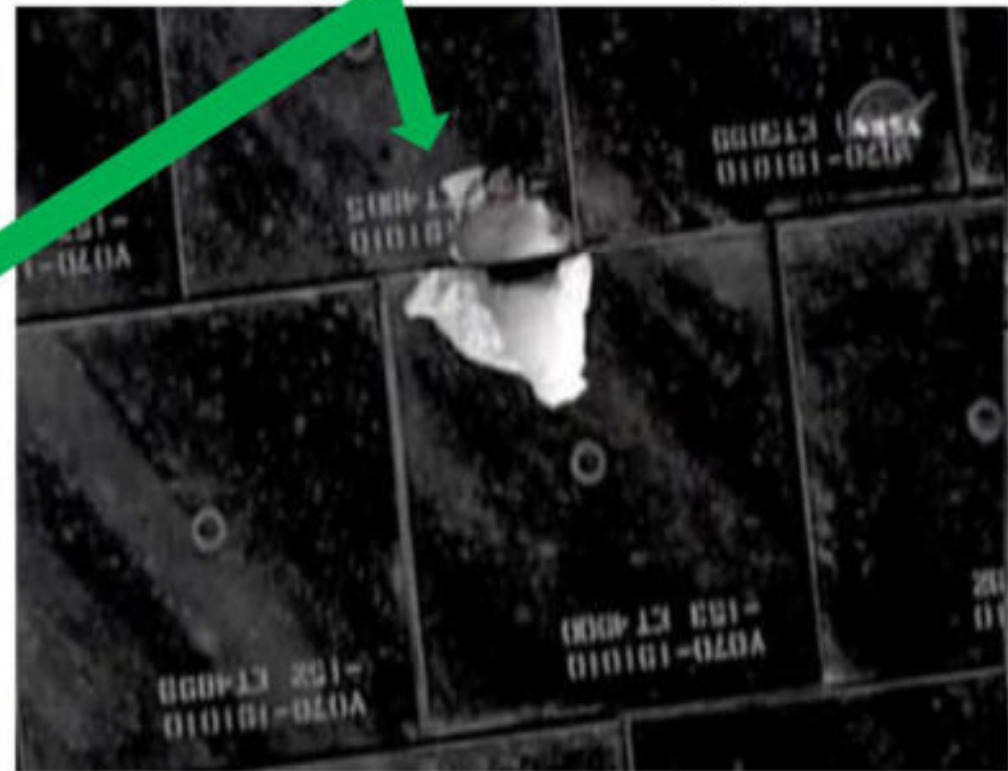
Vrchní strana - poškozený štít
