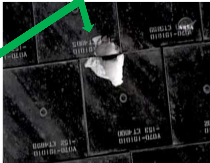
Vrchní strana - poškozený štít
