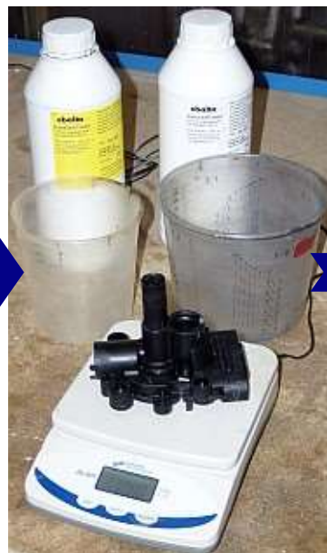
navážení licích složek
