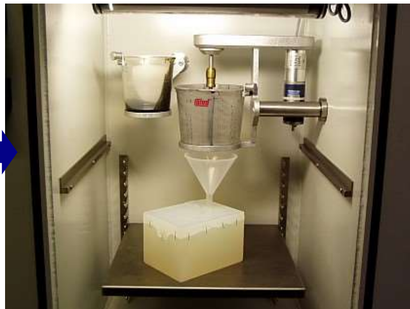
vakuování v komoře
