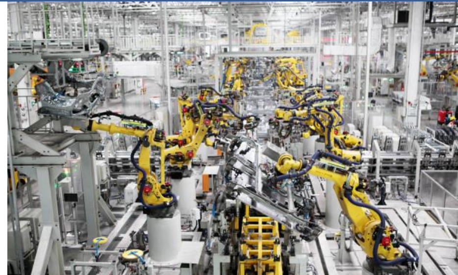
Roboty značky FANUC na lince pro svařování karoserií, grafika: https://www.gettyimages.fi/
