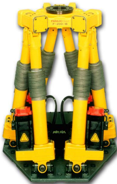
Paralelní struktura FANUC Robotics F-200iB, grafika: https://www.flexibleassembly.com/
