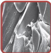
(d) silk fibers showing a trilobal cross-section
