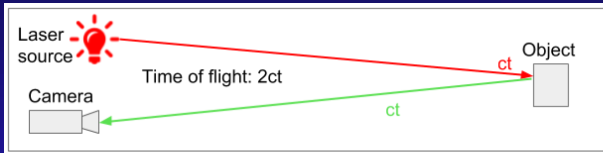
Princip scannování ToF[31]
