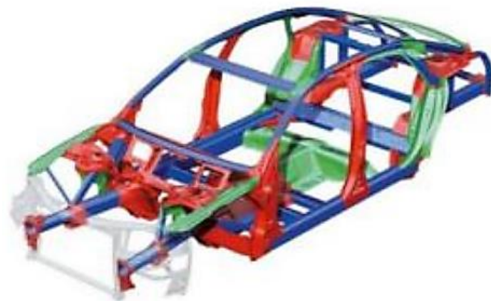
Karoserie Audi A8 – modré – hliníkové profily, zelené – hliníkové výlisky a červené strukturální odlitky
