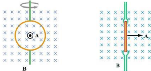
Obr. 10.1.5: Indukce elektromotorického napětí měnícím se úhlem mezi vektory B a A .
