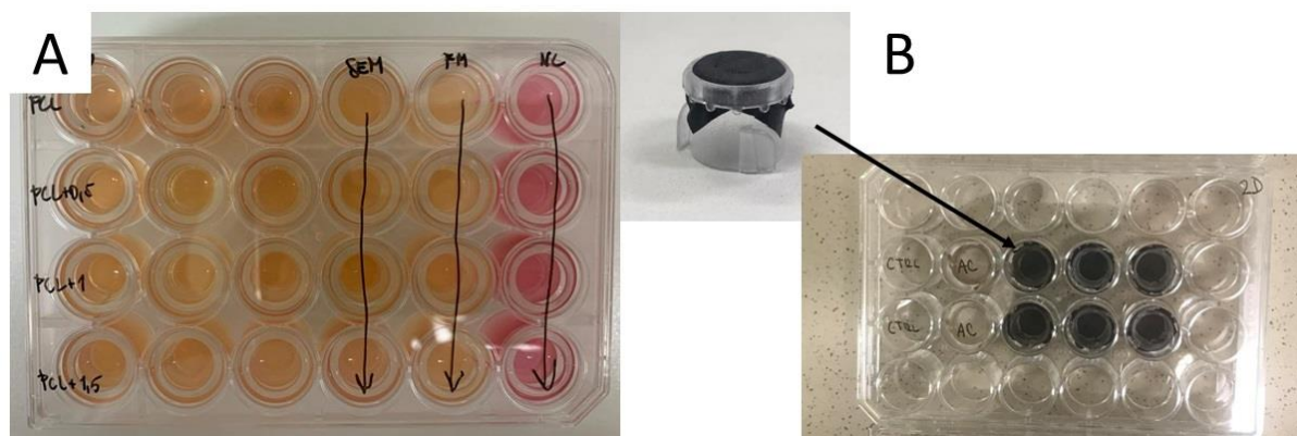
Obr. 19: Zatížení nanovláknenných materiálů pro in vitro testování pomocí skleněných kroužků (A), upevnění modifikovaného nanovláknenného materiálu do speciálního inzertu, vložení materiálů do testovací destičky (B).
